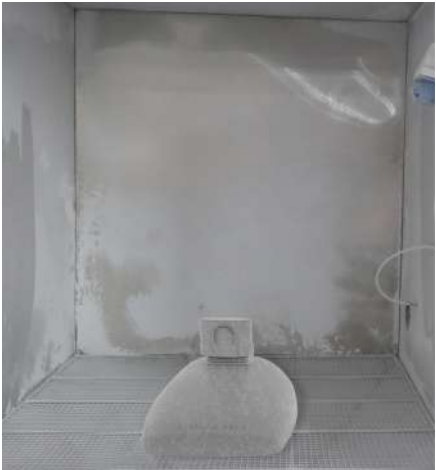
Ensayo Arteike: nube en movimiento continuo de 2 kg/m³ de polvo de diámetro inferior a 75µm.
